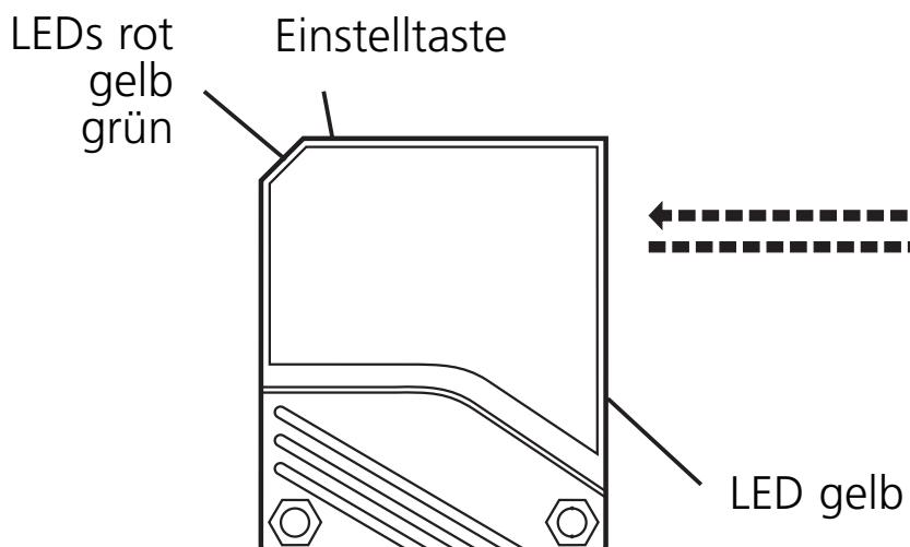
Befestigen Sie Tripelspiegel oder Reflexfolie. Richten Sie die Reflexlichtschranke darauf aus und befestigen Sie sie mit Hilfe einer Montagehalterung; der Lichtfleck muß den Tripelspiegel treffen. Maximale Reichweite nur bei genauer Ausrichtung.
