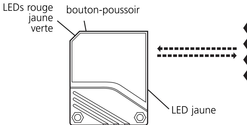
Fixer le réflecteur ou la bande adhésive réflex. Orienter la cellule réflex et la fixer avec une équerre de fixation; le spot lumineux doit toucher
